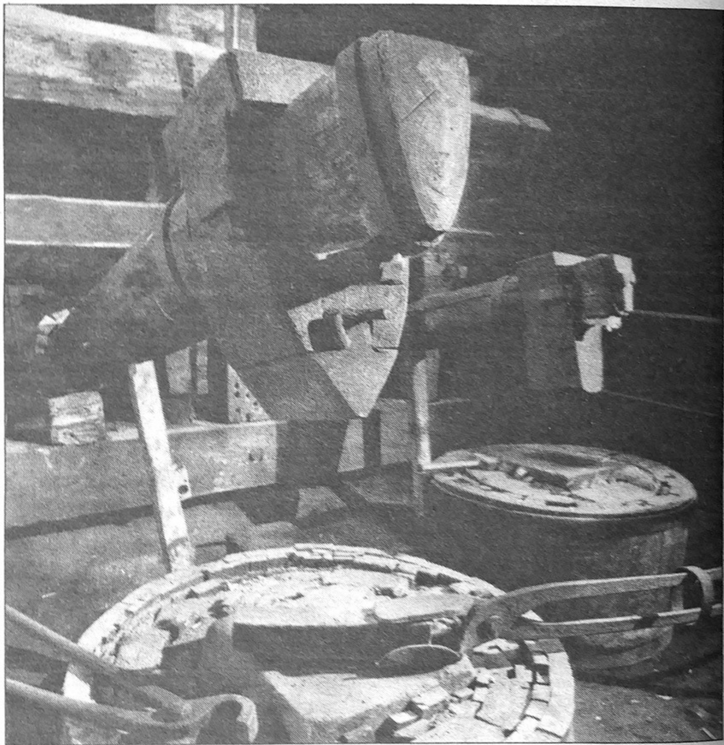
550 JAHRE ALT WURDE DIE FROHNAUER HAMMERSCHMIEDE 1986. Der größte der drei mit Wasserkraft getriebenen Hämmer hat eine Masse von 300 kg.
